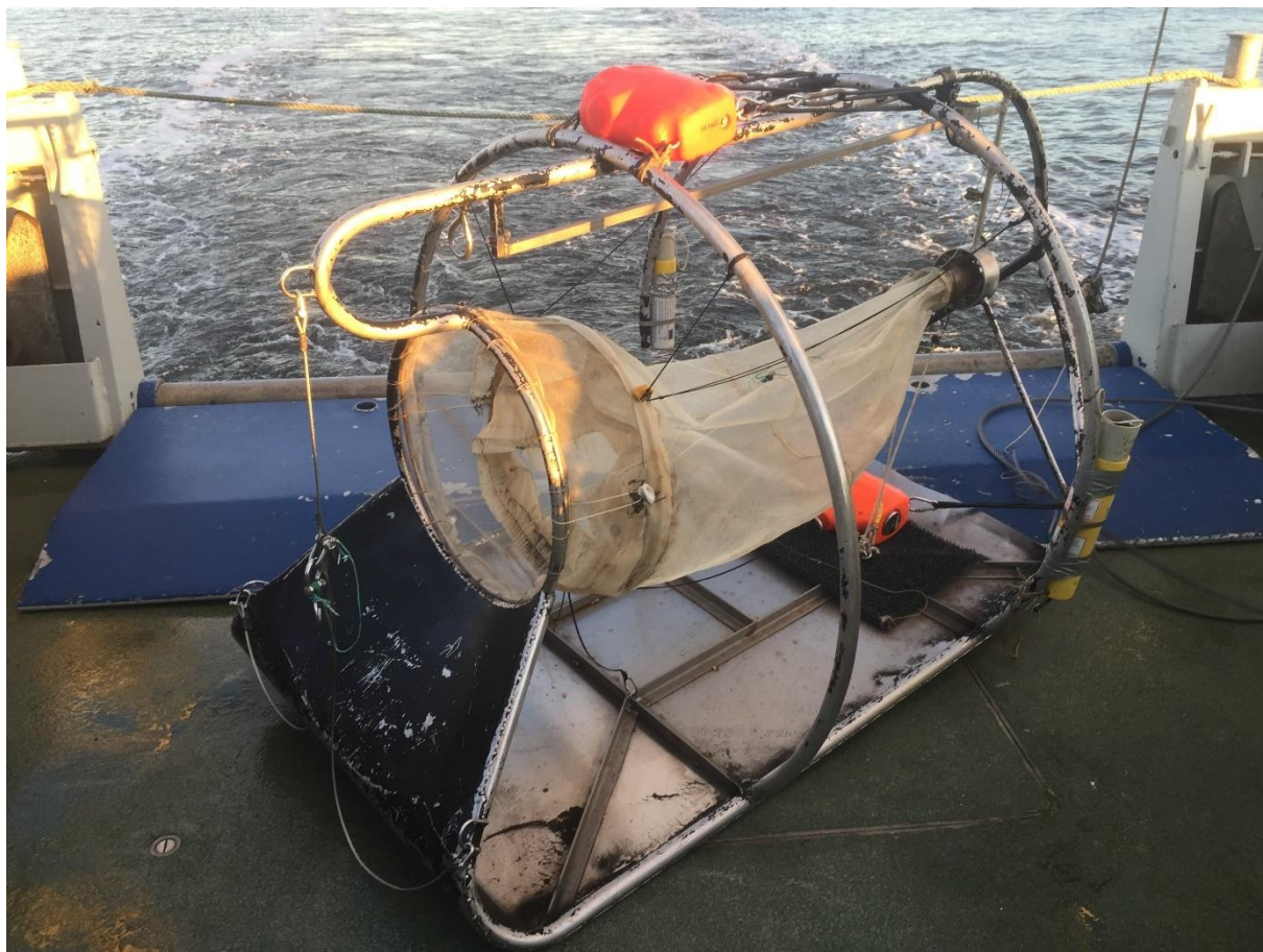
Figur 48. Beyer-slede brukt til innsamling av hyperbentos i utvalgte områder av Indre Oslofjord. (Foto: J. Dolven)
