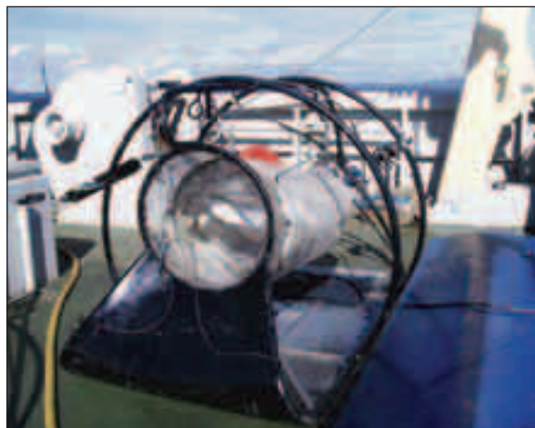
Beyer sleden slepes langs bunnen og fanger inn alle de dyr som lever på og nær bunn, bl.a. reker. Denne blir brukt på de stasjoner som er vist i figur 1 side 7. (Foto J-A Berge)
