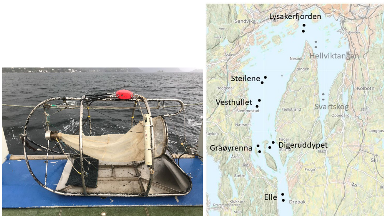
Figur 7. Til venstre vises Beyer-sleden som ble brukt for prøvetaking av hyperbenthos (reker) på syv lokaliteter i Indre Oslofjord i 2024. Foto: NIVA. Til høyre vises kart over lokalitetene for prøvetaking av hyperbenthos (reker) i Indre Oslofjord i 2024.
