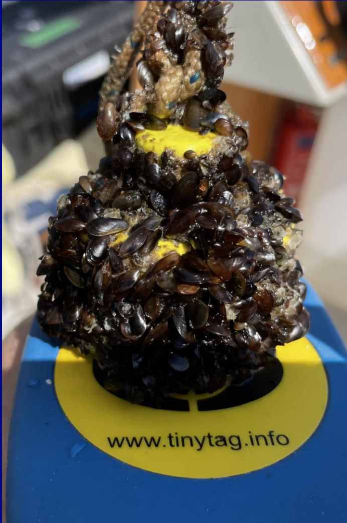
Tett i tett av 6-8 mm store blåskjell på temperaturloggeren
